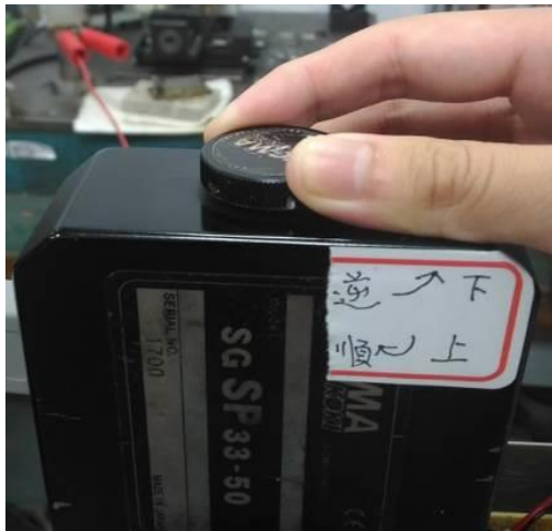
圖（九）手動調整電極間隙圖
