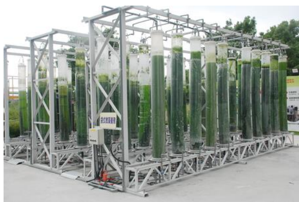
高密度直立式培養系統 (圖片來源：預見雜誌)
