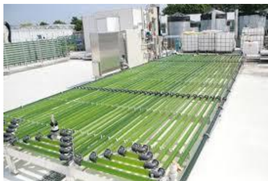
管式光反應器 (圖片來源：上海光語生物科技有限公司)
